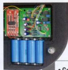
Der Motor des TTT-C wird bis zu 20 Stunden von Spezialakkus ohne Memory-Effekte versorgt – hier samt Steuerung
