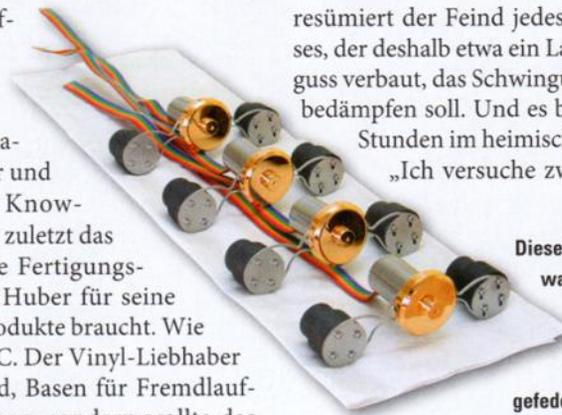
Diese TTT-C-Motoren warten auf den Einbau. Gut zu sehen sind die zwecks Entkopplung gefederten Aufhängungen
