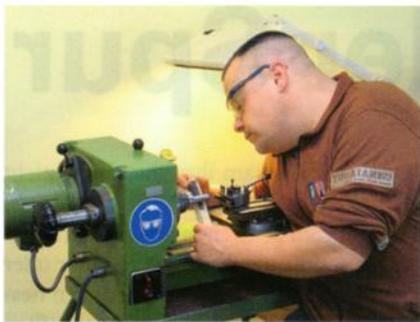
Bei der Produktion ist viel Handarbeit gefragt. Hier wird eine Tellerachse nach alter Technik mit Lindenholz und Diamantpaste poliert
